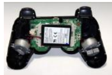
Figuur 37, Gaming Controller met Dual Shock (twee motoren links en rechts in de handvaten)
