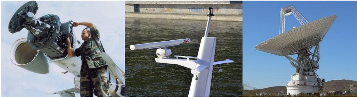
Figuur 18, Toepassingen van radar, van links naar rechts: radar in de neus van een F18 straaljager, radar op een mast van een schip, radar voor het detecteren van objecten in de ruimte
