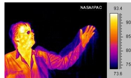
Figuur 24, Thermal Imaging, weergave van warmte met behulp van een infrarood camera. Rechts in de figuur staat een schaalvoor temperatuur in Fahrenheit
