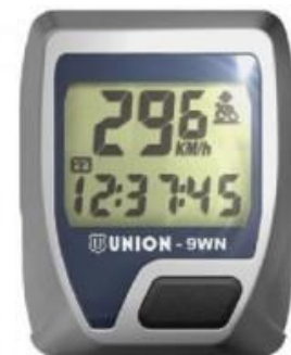
Figuur 43, Fiets kilometer-teller met simpele weergave van informatie op beeldscherm. Een enkele knop wordt gebruikt voor aan/uit zetten en het wisselen van informatie modus.
