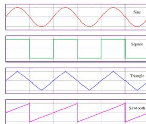
FIGURE 5. FOUR COMMON WAVEFORMS
