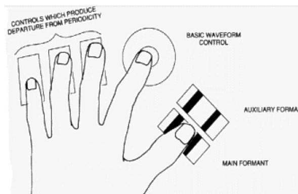
FIGURE 8. TIMBRE CONTROL OF THE ELECTRONIC SACKBUT
