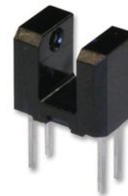
FIGUUR 41 - OPTISCHE SENSOR
