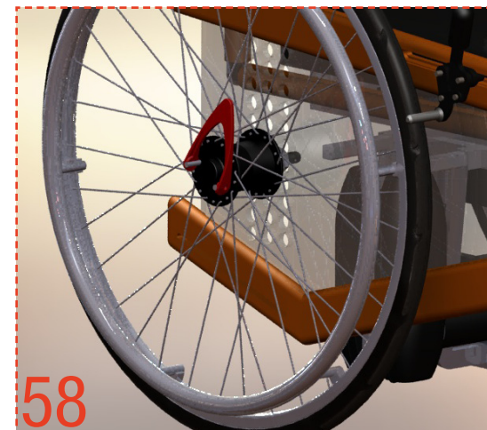
Figuur 57. Bovenframe Figuur 58. Ophanging hoepelwiel
