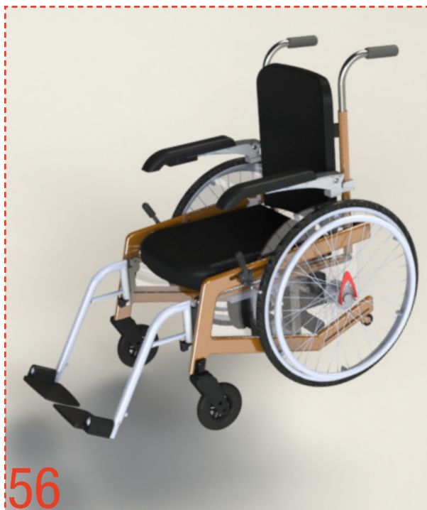
Figuur 53. Frame schetsen Figuur 54. Rechter deel onderframe Figuur 55. Schetsen van jasbeschermers Figuur 56. 3D- model totaal
