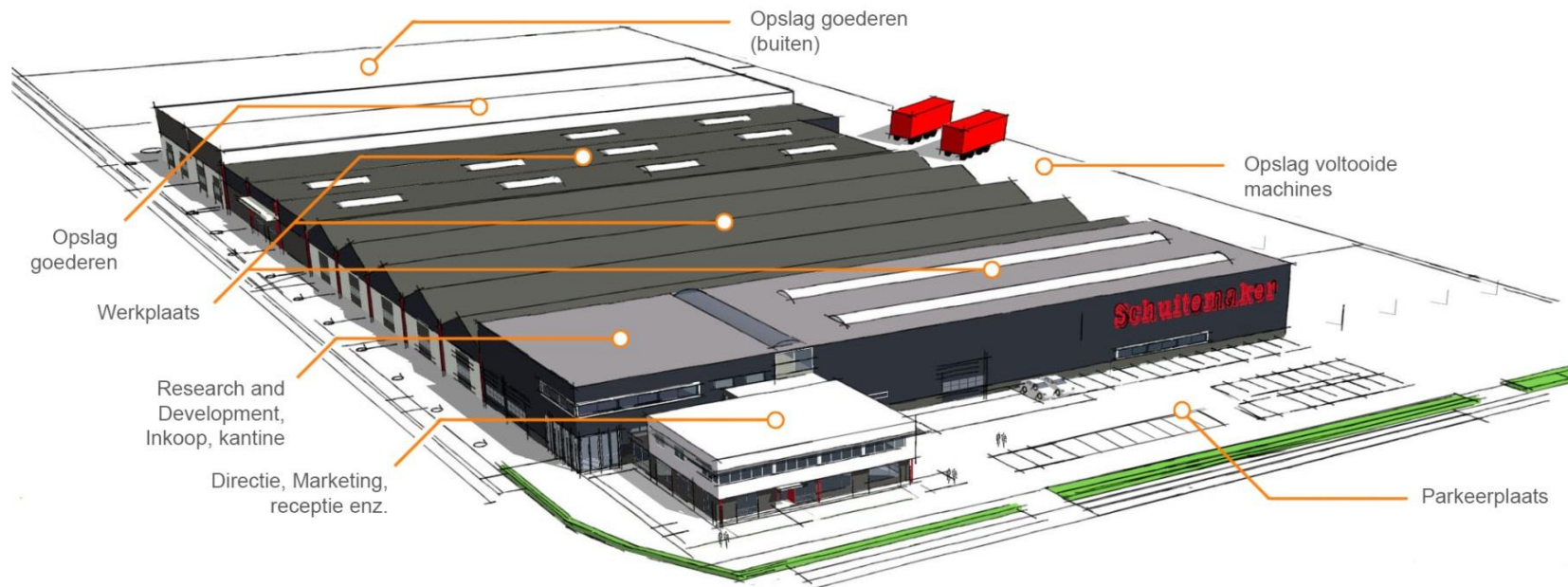
Figuur 2: Samenstelling Schuitemaker bedrijfsgebouw
