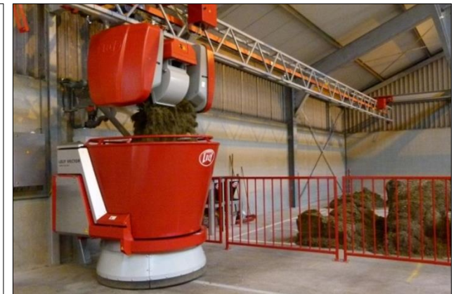
Figuur 27: Lely Vector voerrobot met voerkeuken
