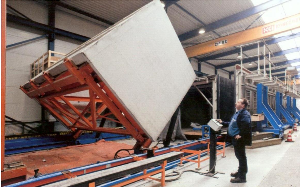
Het kantelmechanisme waarin de units worden gestort
