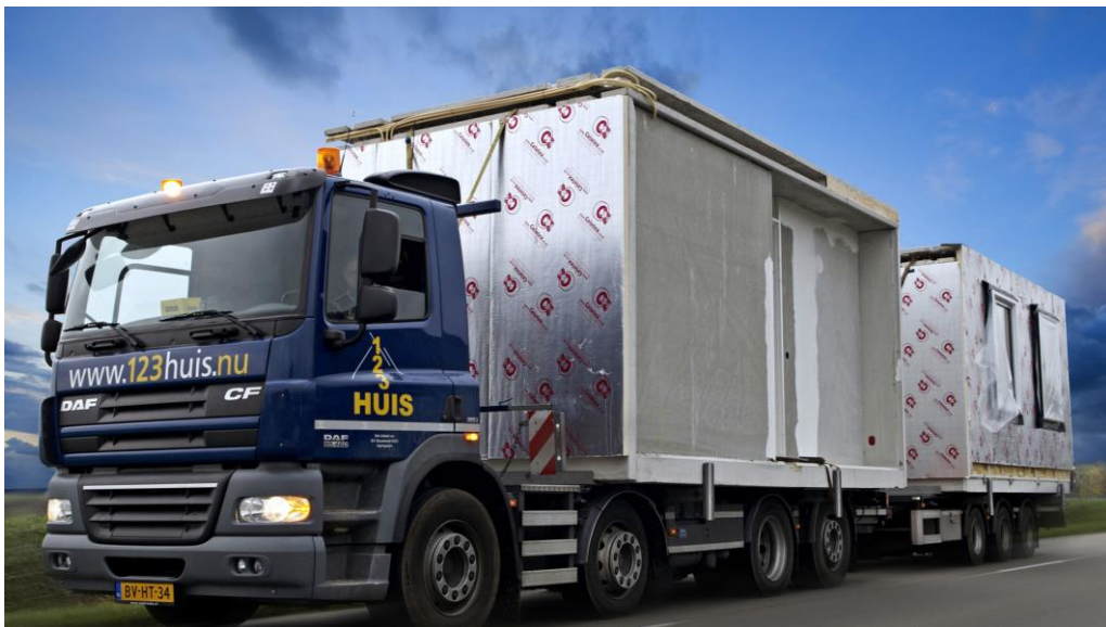
Transport van de units naar de bouwplaats
