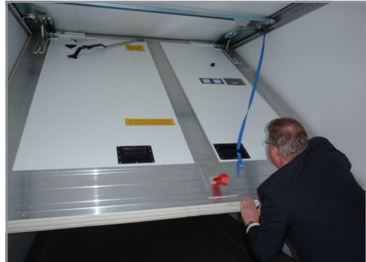
Figuur 2.7 - Solide wand uit één geheel Bron: W.R. ten Klooster
