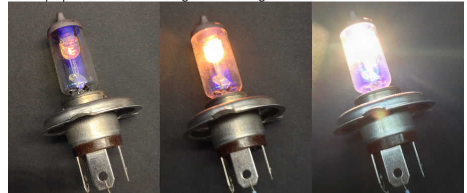
Figuur 7.3 Ook de halogeenlamp geeft meer licht bij een grotere ratio
