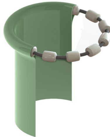
Figuur 43: Doorsnede van de kokervormige stof waardoor te zien is hoe de ring in de rand van de stof zit.
