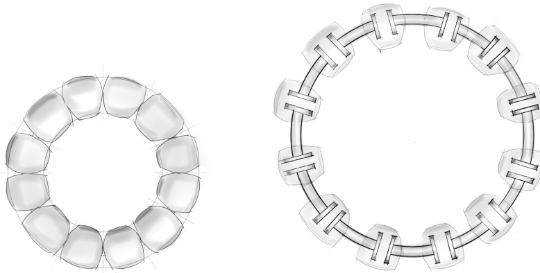
Figuur 37: Ontwerp 3. In de rechter afbeelding zijn de rolletjes doorzichtig weergegeven waardoor de flexibele pennen in het geheel zichtbaar zijn
