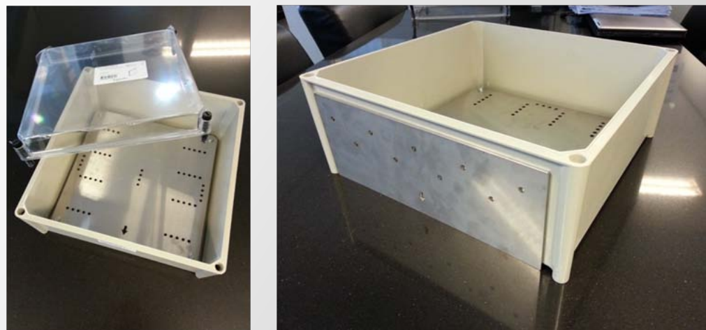
Afbeelding 4.13 Besturingskast met voorbereikte montage plaat
