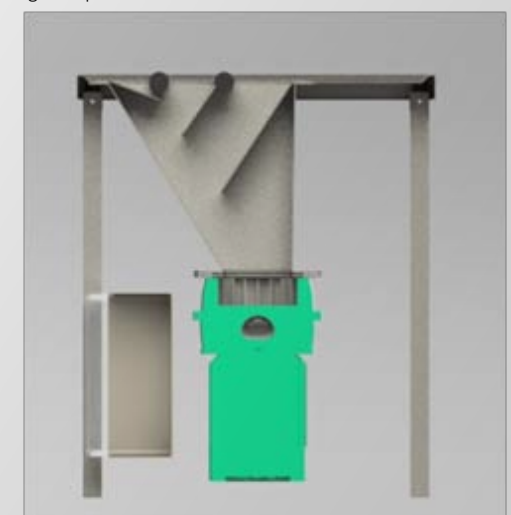
Afbeelding 3.7 Trillingsdempende rubbers boven in het frame
