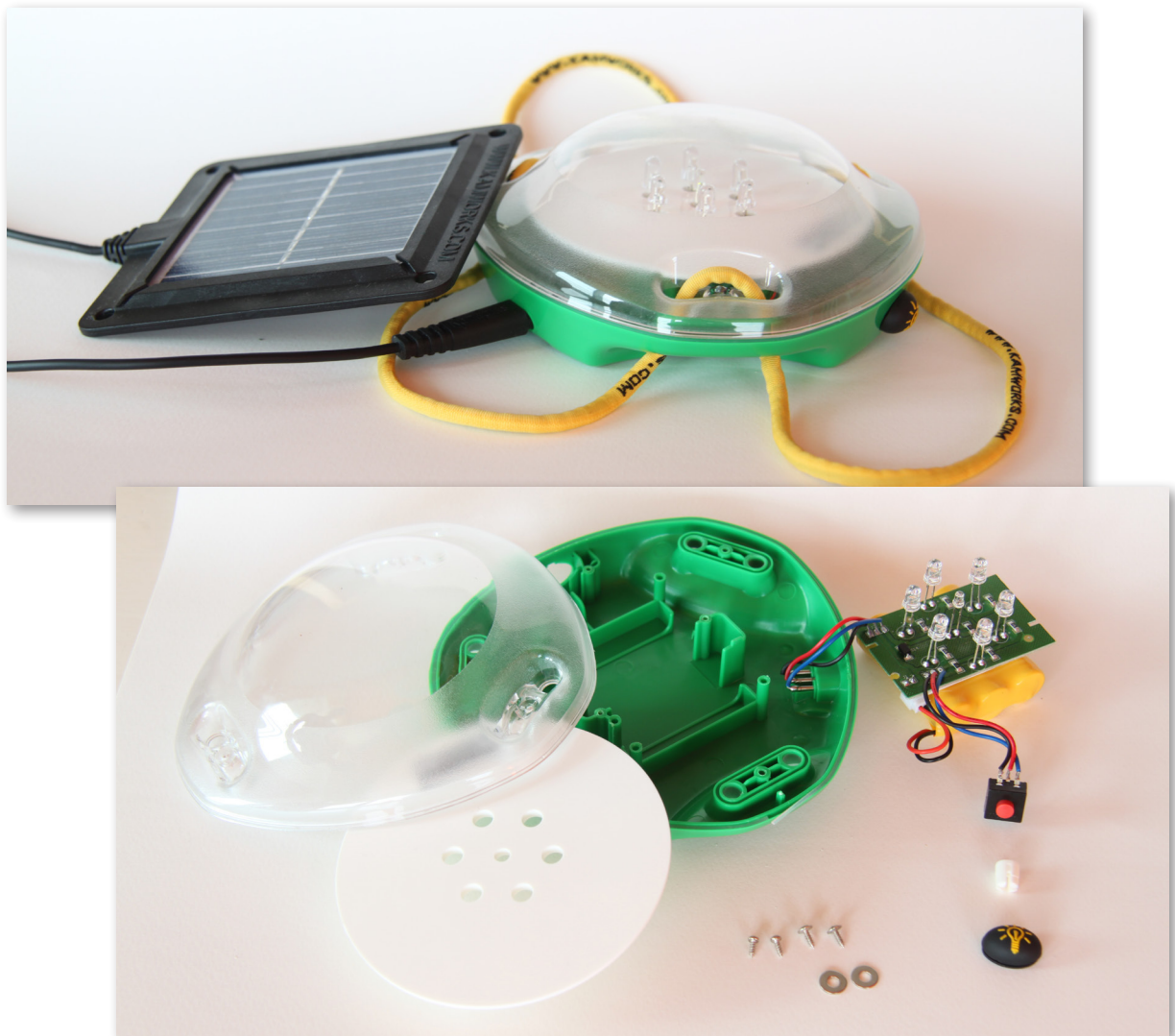
figuur 23: De MoonLight van Kamworks, boven: het product, onder: alle losse onderdelen
