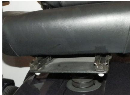
Figuur 10: Mechanisme in autostoelen. De stoel beweegt over een rails. De gebruiker kan vaak aan de voorkant van de zitting een hendel omhoog trekken om te klem los te halen. De hendel schiet vanzelf weer terug zodra de gebruiker de hendel loslaat.
