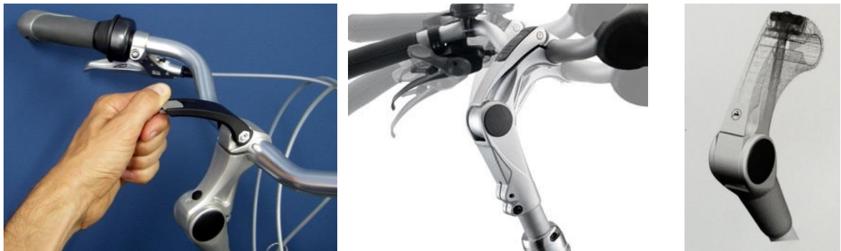
Figuur 6: De switch is een onderdeel wat in fietssturen wordt gebruikt. De gebruiker kan dan twee scharnierpunten instellen na het loshalen van slechts één hendel.
