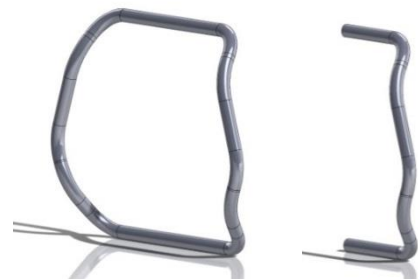
Figuur 98 : Het buizenframe bestaat uit twee delen.
