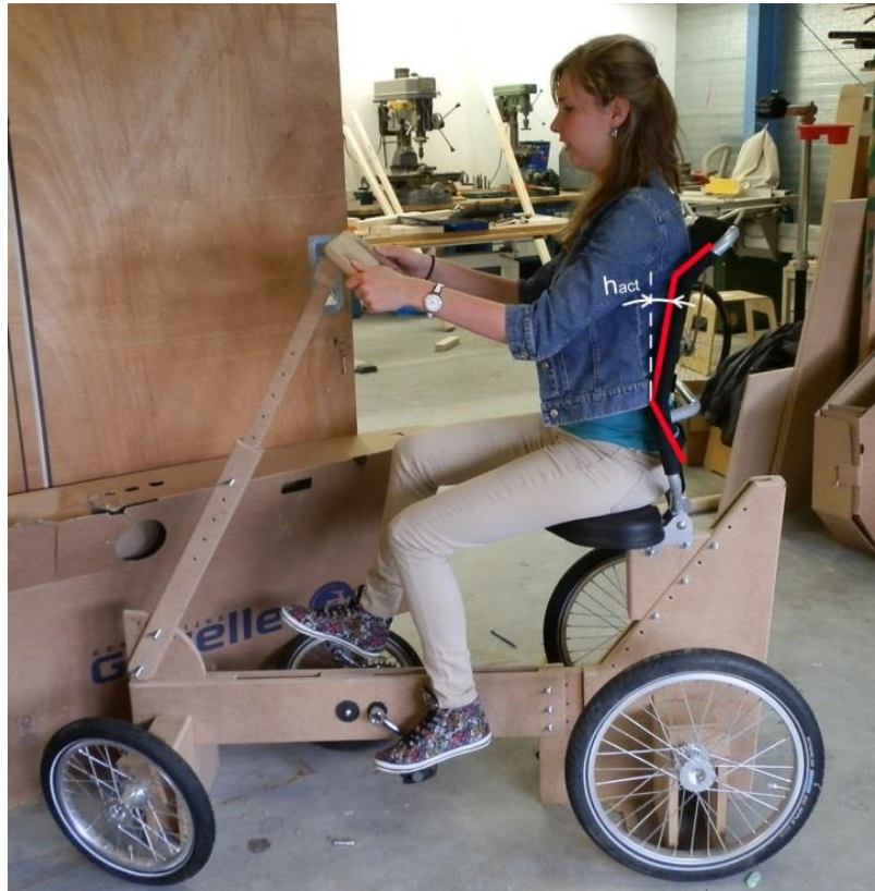
Figuur 1: Actieve zithouding. h_{act} is de hoek die de rugleuning zal maken bij de actieve zithouding. h_{act} is vastgesteld op 10^\circ .
