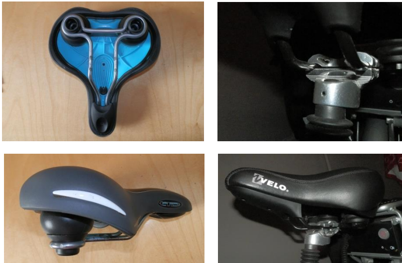
Figuur 13: De fietszadel werkt precies andersom. De 'rails' is nu bevestigd aan het zitvlak en het mechanisme aan de vaste wereld. De 'rails' heeft hier de vorm van een buis. De fietszadel wordt d.m.v. een klemkracht op zijn plek gehouden.
