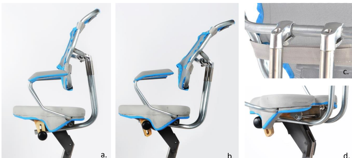
Figuur 130: Het rugleuning kan naar voren en naar achteren roteren en de rugleuning kan ook los gekanteld worden.
