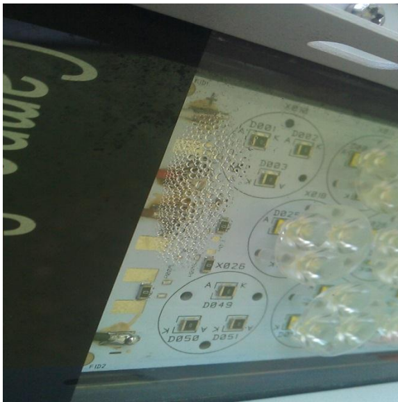
Figuur 4.1 – Schadelijke condensvorming in de LED-lampen (foto: Vrolijk & Overgaauw)
