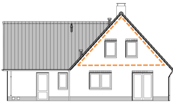
Figuur 32: Gevelaanzicht SelektHuis woning type Jungfrau, met in oranje aangegeven één van de drie topgevels van deze woning.
