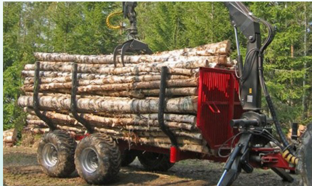
Afb. 55 - Houttrailer met hijskraan
