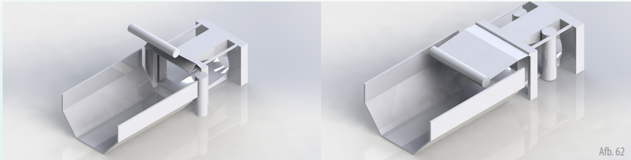
Studie 2: Invoer in de machine vanuit de beweegbare cilinder. Daarna compressie door twee cilinders welke het takhout vervolgens door de machine geleiden.
