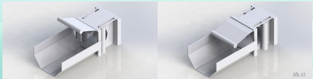
Studie 1: Voornamelijk invoer vanuit getande cilinders. Eerst druk vanuit beweegbare cilinder, om takhout in de machine te voeren. Daarna twee drukcilinders welke het materiaal door de machine trekken.
