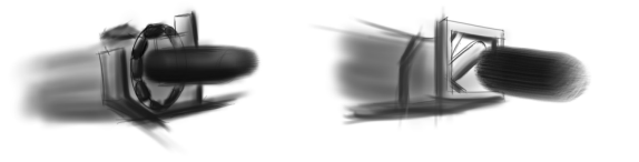
Afb. 26 - Wanneer de bundel is samengedrukt wordt het touw gewikkeld
