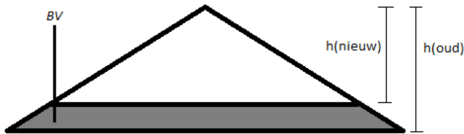
Figuur 28. Berekening van verworven hoogte voor bouw in horizontale lagen, door middel van vergelijking van de inhouden van twee kegels.
