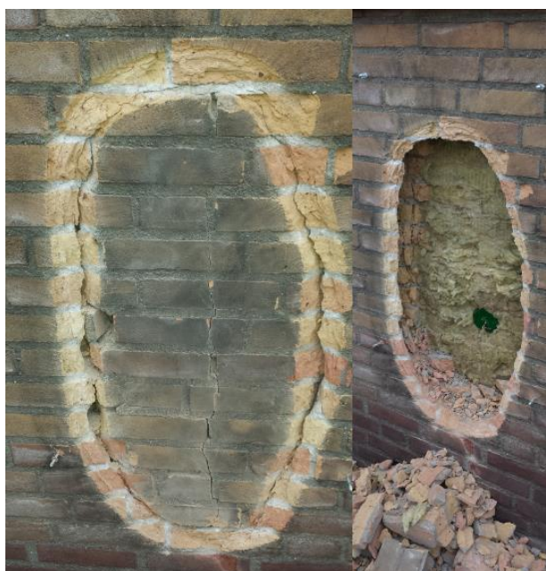
Figuur 58: resultaat proef 13, links direct na afzetten, rechts na verwijderen van binnenring.
