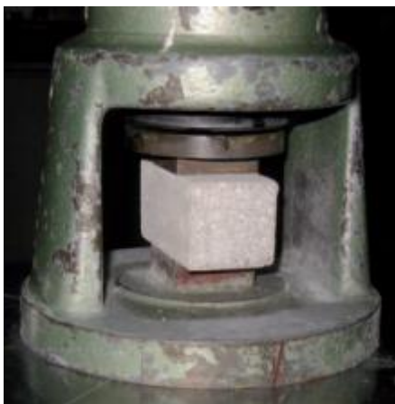
Figuur 21: proefopstelling drukmeting baksteen.
