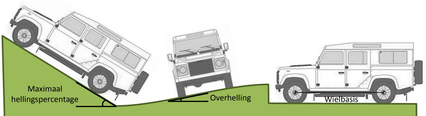
Figuur 41: v.l.n.r. maximaal hellingspercentage, maximale overhelling en wielbasis.
