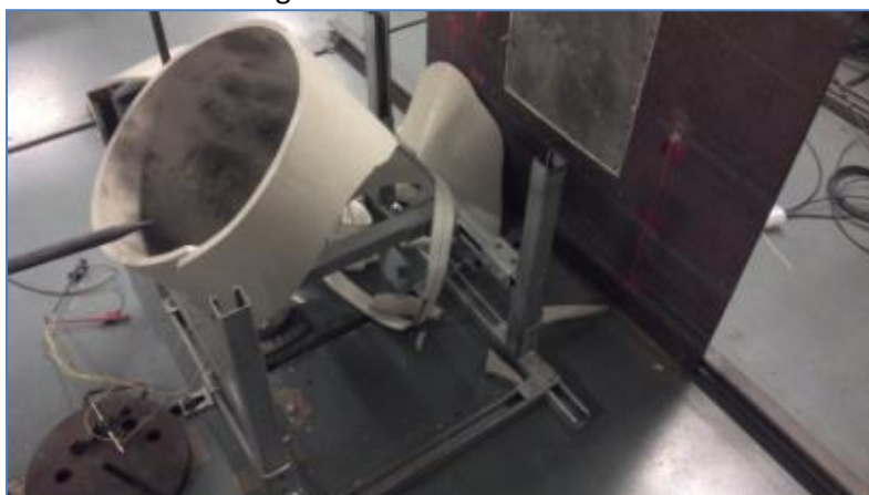
Figuur 39: Bezweken tunnel na uitvoering van proef 40.
