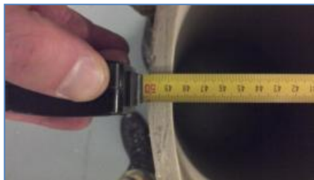
Figuur 36: Tunneldiameter (horizontale as)
