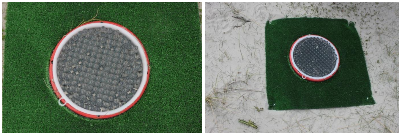
Figuur 7: De "nieuwe MDCO" te midden van een kunstgrasmatje ter voorkoming van het invangen van spaterosie en invang door dierlijke activiteit (foto's afkomstig van dhr. M. Riksen)
