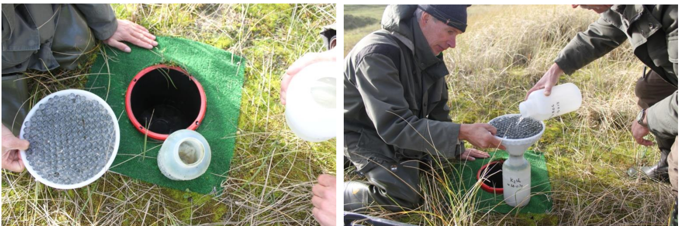
Figuur 20: a) De "nieuwe MDCO" met extern opvangreservoir komt (foto's (13-11-2013) afkomstig van dhr. M.Riksen)
