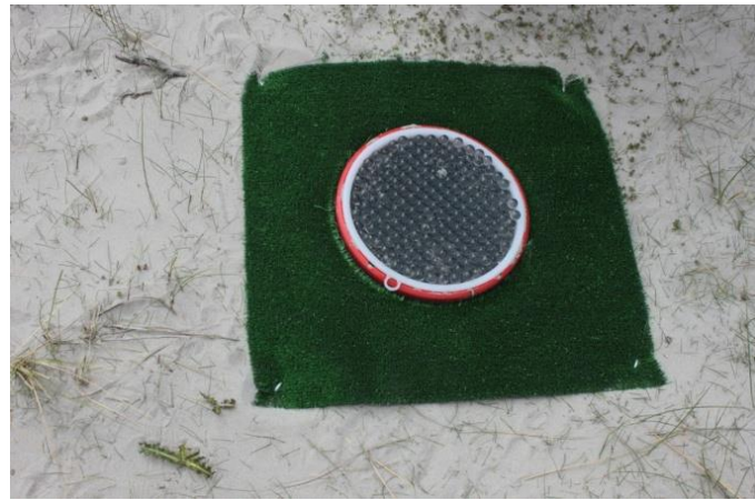
Figuur 21: De “nieuwe MDCO” te midden van een kunstgrasmatje ter voorkoming van het invangen van spaterosie (foto's afkomstig van dhr. M.Riksen)
