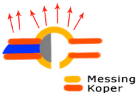
Afbeelding 5.1: Schematische tekening van de 3-weg-klep
