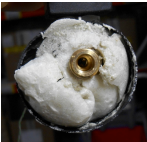
Afbeelding 5.3: Zij aanzicht van de PUR-geïsoleerde messing 3-weg-klep
