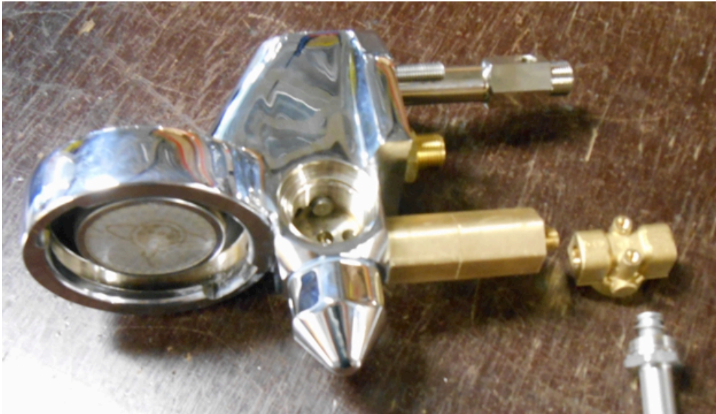
Afbeelding 5.2: Het groepshoofd met het messing verbindstuk en de messing groepsklep
