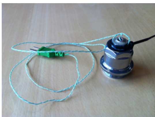
Afbeelding 2.6: Foto van de moer aan de zijkant van het groepshoofd
