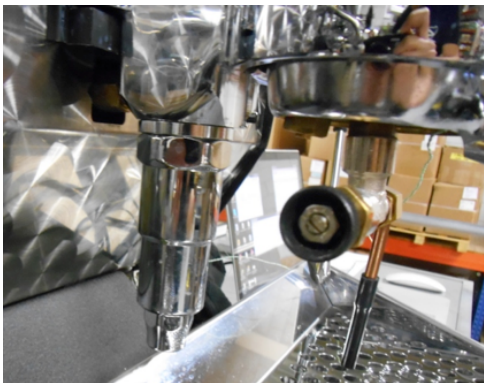
Afbeelding 7.9: PPI bevestigd in het groepshoofd
