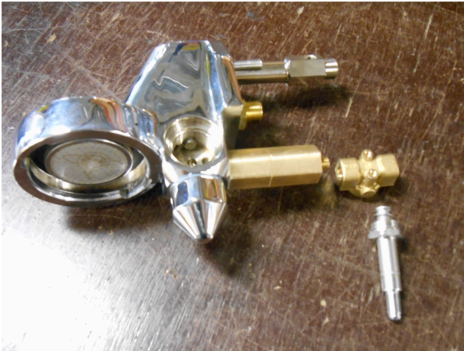
Afbeelding 4.5: Alle onderdelen voor de verbonden 3-weg-klep
