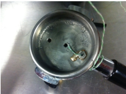
Afbeelding 2.10: Bovenaanzicht van de aangepaste blindfilter
