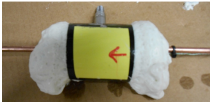
Afbeelding 4.3: Klep nadat het PUR-schuim is gespoten
