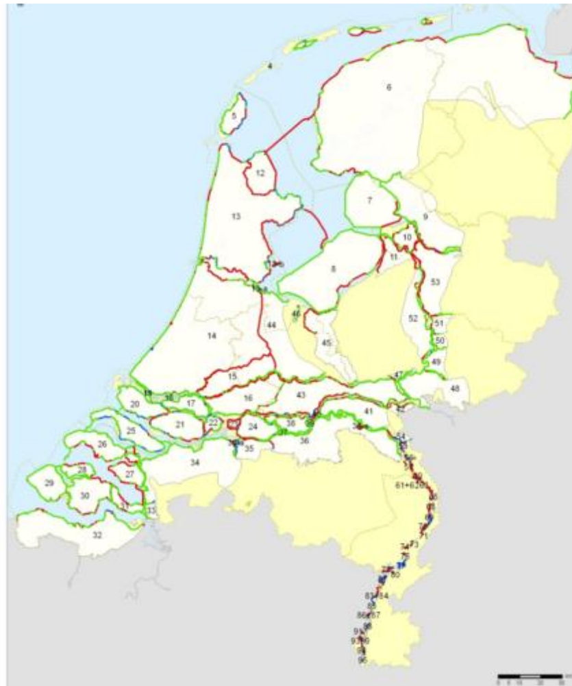
Figuur 1.2: De dijkringen met groen zijn de primaire keringen die aan de wettelijk norm voldoen volgens de derde toets primaire waterkeringen. De rode dijkringen voldoen niet aan de wettelijke norm
