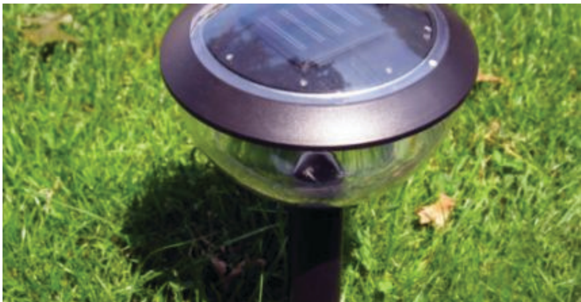
Afbeelding 7: Geïntegreerde PV-cel in een tuinlamp
