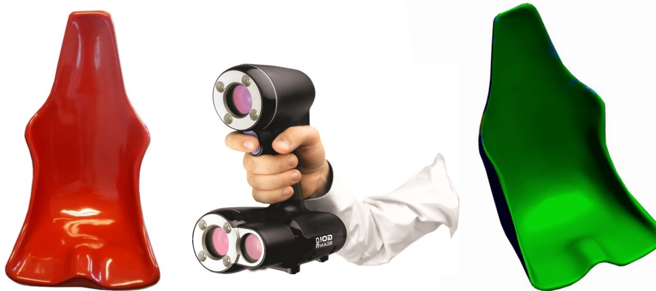
Figuur 171 - v.l.n.r. De gekochte bestuurderstoel; de 3D-laserscanner dat gebruikt is voor het inmeten; het resulterende CAD-model
