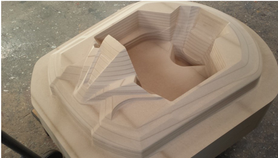
Figuur 196 - De productieplug voor de mal van de cockpitrand
