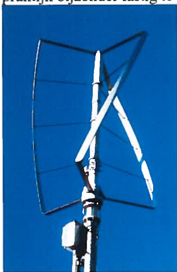
Figuur 12: de Turby. Door de verticale as is het rendement niet afhankelijk van de windrichting (bron: Turby)
