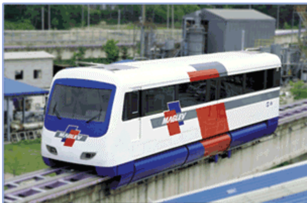
Figuur 2.6 De Zuid-Koreaanse UTM-01 op zijn testtraject 28
