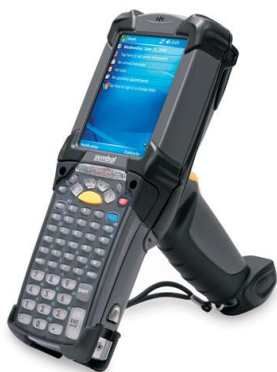
Afbeelding 2: Een PDA met ingebouwde barcode scanner
