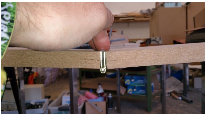
Fig. 8.10: Scharnier en resulterende doorbuiging
