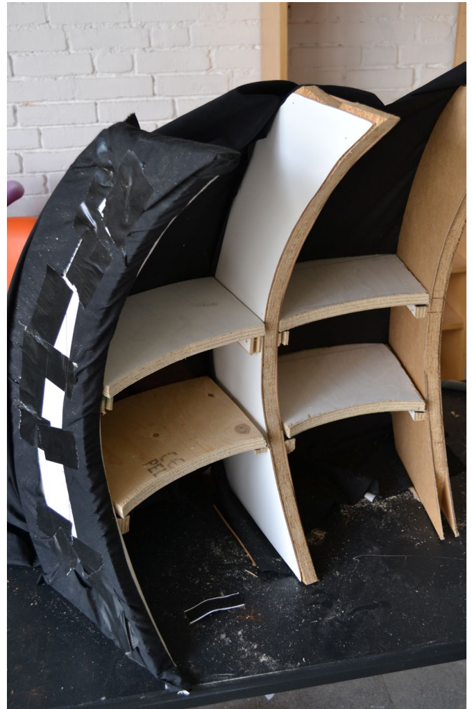
Fig. 7.11: proefmodel van in textiel verwerkte dragende elementen
