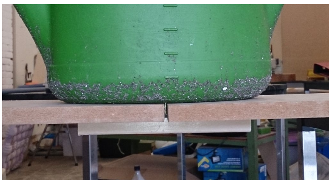
Fig. 8.13: Horizontaal balk onder de constructie vermijdt doorzakken.
