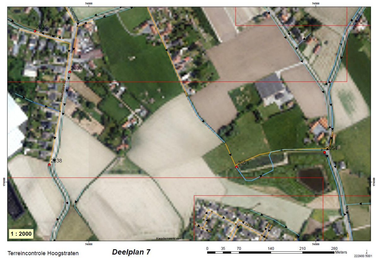
Figuur 44: Eén van de deelplannen waarop duidelijk naar voren komt op welke locaties de in- en uitlaten gesitueerd zijn
