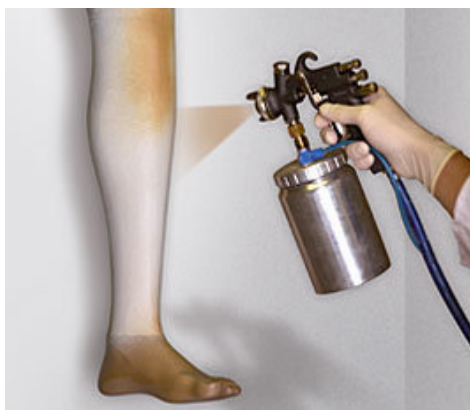
Abeelding 7 - Aanbrengen van de coating
