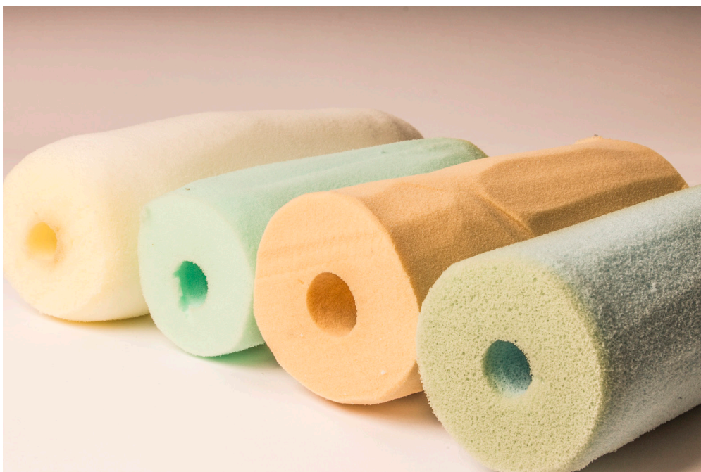
Abeelding 22 - Verschillende schuimen (van links naar rechts; PE-8000, PE-SG40, PE-9020, Koudschuim)
