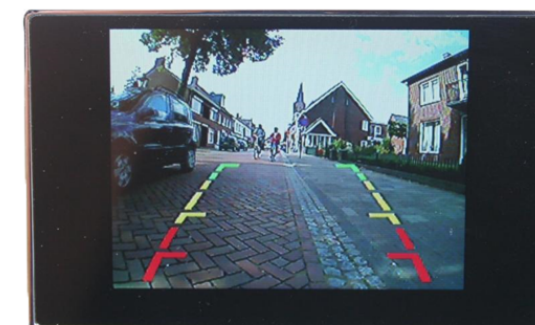
Afbeelding 10: Het zichtveld en de indicatiestrepen van de camera in gebruik.
