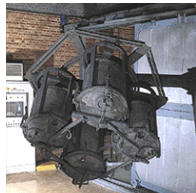
Afb. 11.10: Het proces van rotatiegieten
