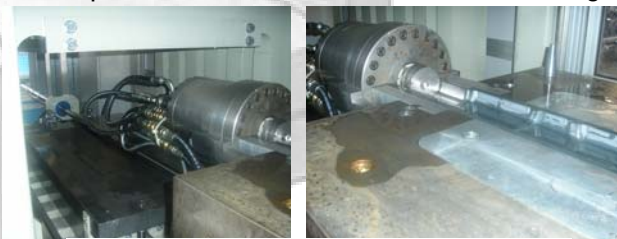
Afb. 11.9: Links de pers en rechts de mal waarin het proces plaatsvindt
