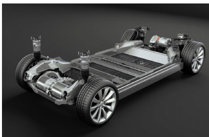
Figuur 4.13: Platform frame
