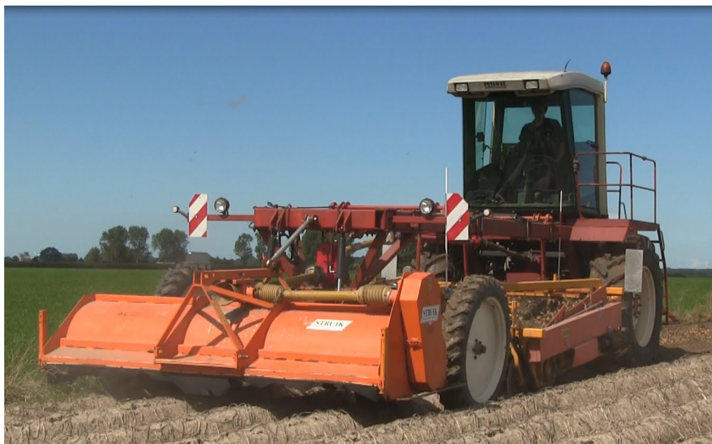
Figuur 7.1: Werktuigdrager + werktuigen aan de voorste en middelste hefinrichting
