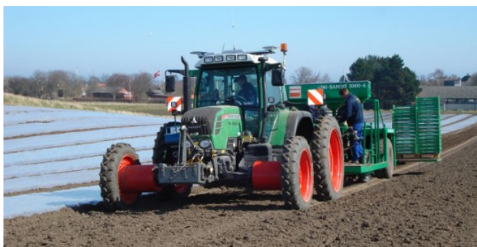
Figuur 7.3: Verbreedde tractor met stalen spacers
