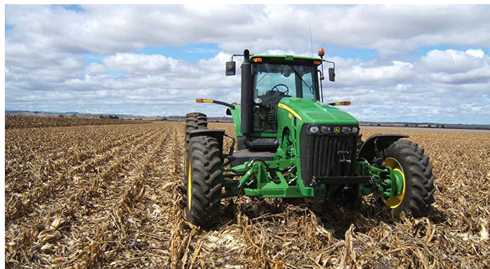
Figuur 7.4: Verbreedde tractor met verlengde assen
