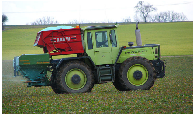
Figuur 5.30: MB Trac met zaai-installatie op laadvloer
