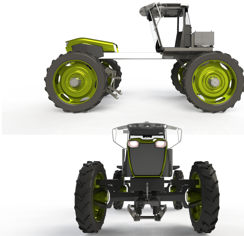
Figuur 10.1: Uitvoering 1 - Grote wielbasis, grote spoorbreedte
