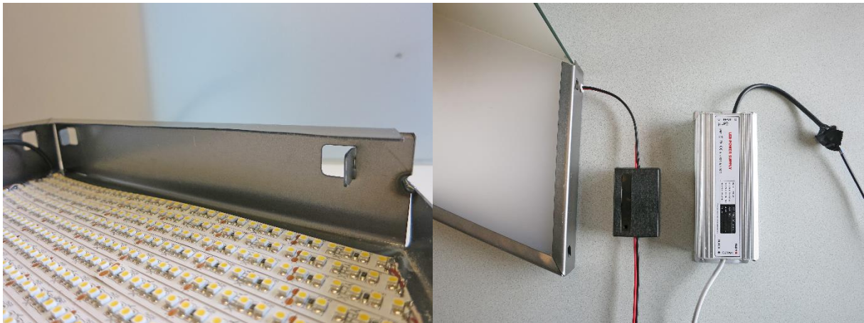
Figuur 8-16 LED's in behuizing (links), Arduinkastje en voeding (rechts)
