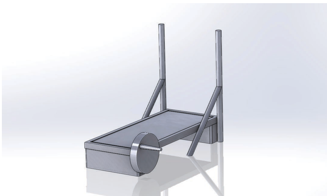
Figuur 3.9 Een instelbare magneetrem wordt bij de achterste as geplaatst. Daarnaast worden er palen voor het elastiek geplaatst
