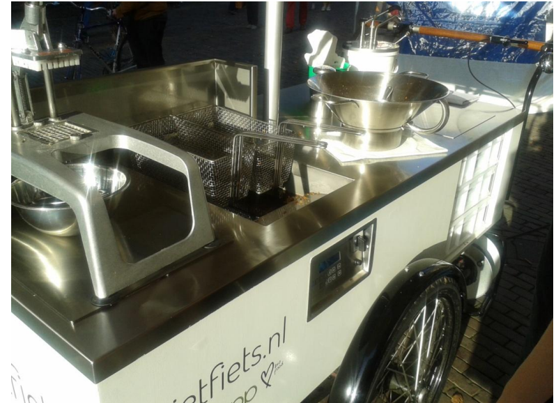
Afbeelding 1.1: De indeling van de Frietfiets v.l.n.r.: gas, frituurinstallatie, parasol en opslag.
