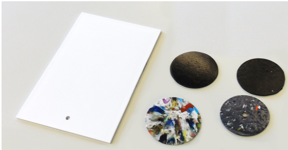
Figuur 2.19 Sample met poedercoating
