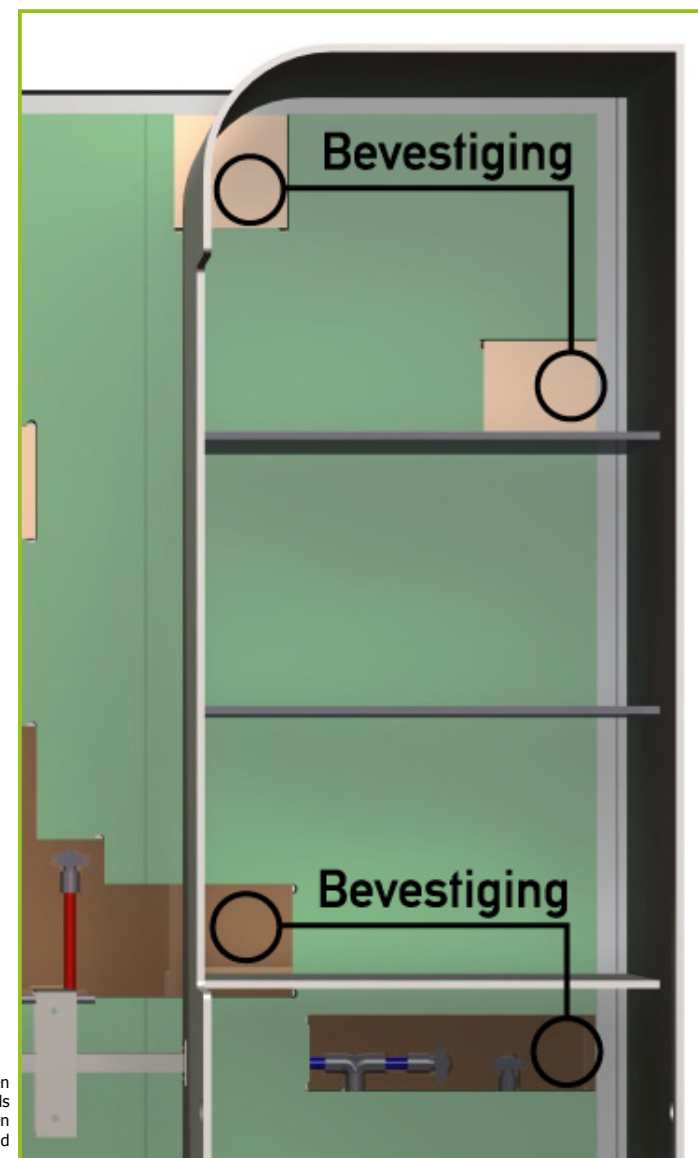
Overzicht van de keukenkast en de klossen die gaan fungeren als bevestigingspunt. Deze klossen zitten al in de huidige achterwand van de unit.
