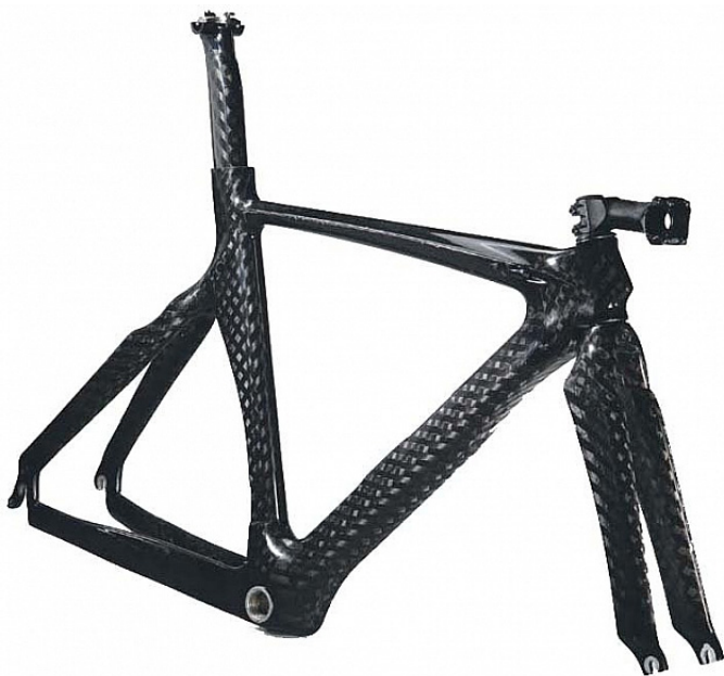
Afbeelding 4: Koolstofvezel racefietsframe (Wikimedia Commons)
