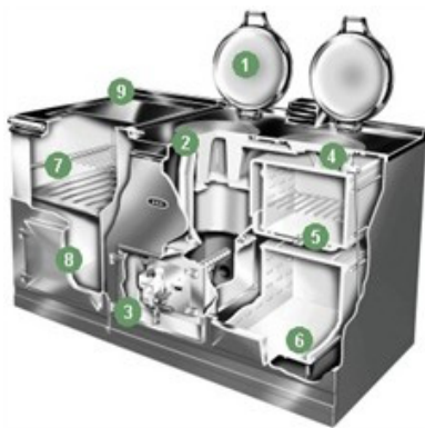
Afbeelding 15: Een AGA cooker gebruikt verschillende kamers voor variatie in temperatuur (agaliving.com)
