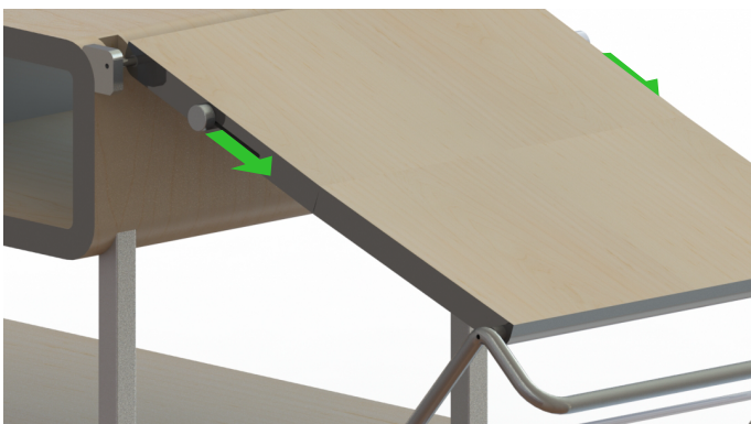
Afbeelding 47: Door de knoppen naar voren te schuiven wordt het blad vergrendeld.
