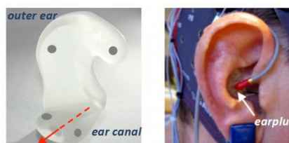
Fig.C.5 – Ear-eeeg: Links oor-plug met elektrodes zichtbaar (grijze puntjes), rechts testopzet van Ear-eeeg in combinatie met on-scalp EEG (muts).
