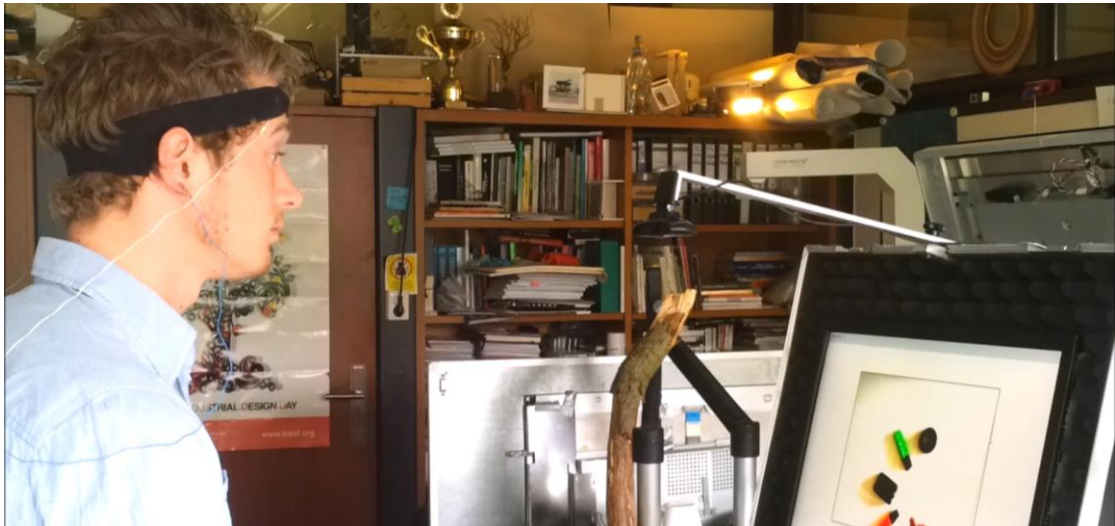
Fig. 6.12 – Het uitvoeren van ‘Captures’, foto’s maken met de camera van de LFDS door middel van het uitvoeren van een frons.
