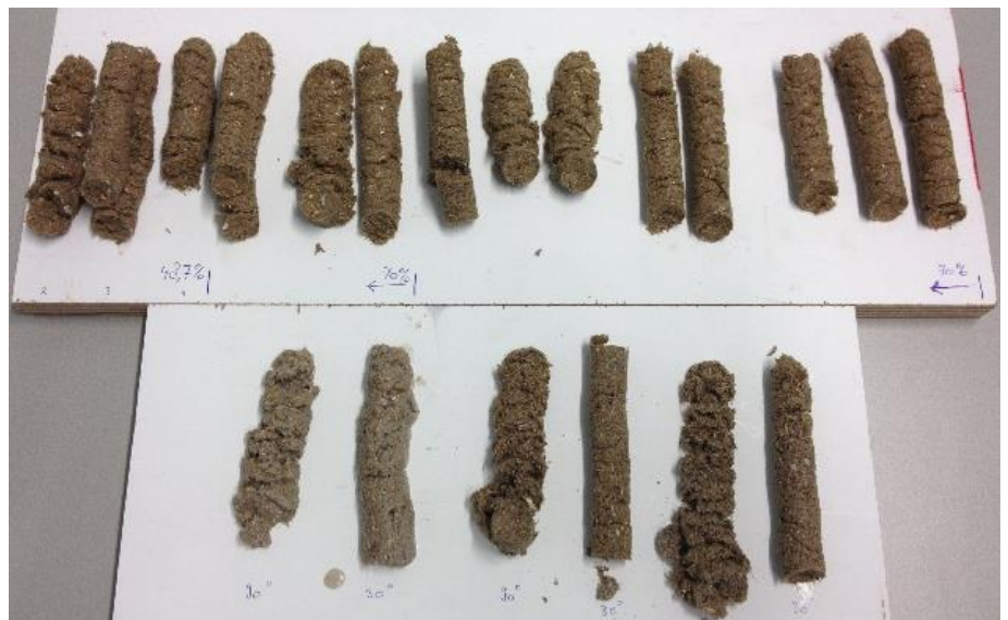
Figure 31 - Vergelijking van de reproduceerbaarheidstest (boven) met de strepen met hoger percentages uit experiment 2 (onder).
