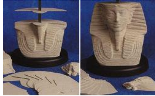
Figure 2 - Voorbeeld voor het opbouwen van een product uit laagjes.
