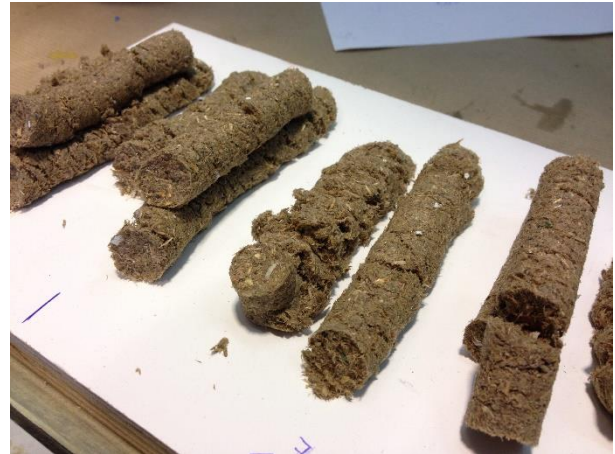
Figure 30 - Close-up resultaten reproduceerbaarheidstest. Het verschil tussen verticaal en horizontaal extruderen is duidelijk te zien. De gestapelde strepen zijn vormvast, de onderste laag belastbaar.
