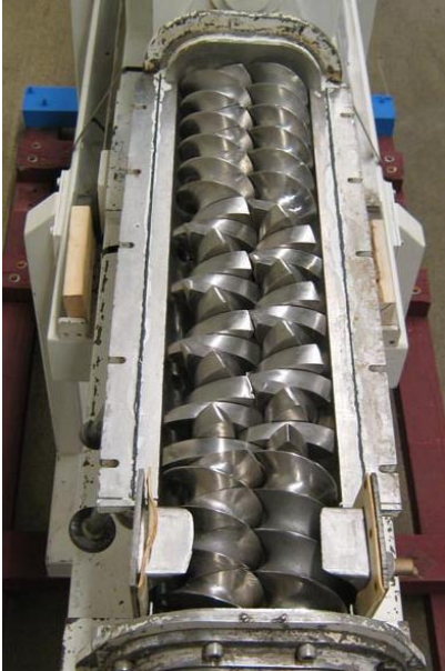
Figure 49 - Dubbele schroef extruder met mengelementen.
