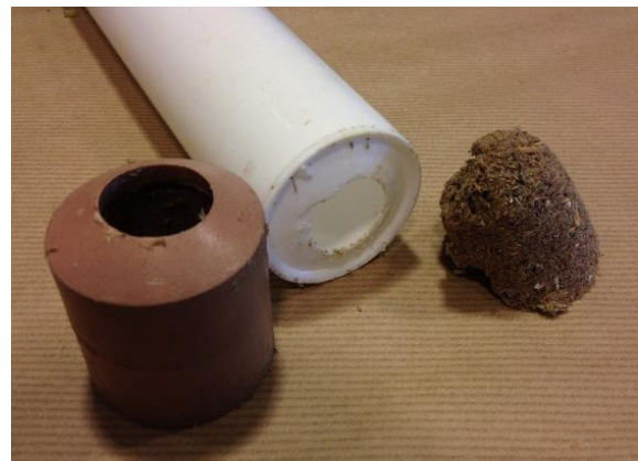
Figure 34 - De uitgeboorde insert, kitkoker en een reststuk van het mengsel
