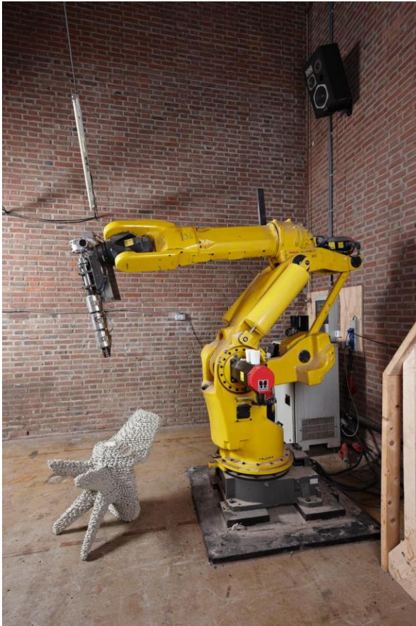
Figure 66 - Robotarm 3D printer met kunststof extruder van Dirk van der Kooij
