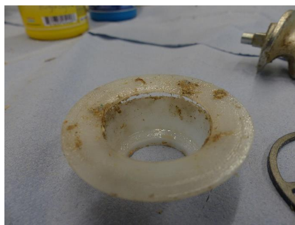
Figure 38 - De scheur in de trechter zit voor de versmalling.
