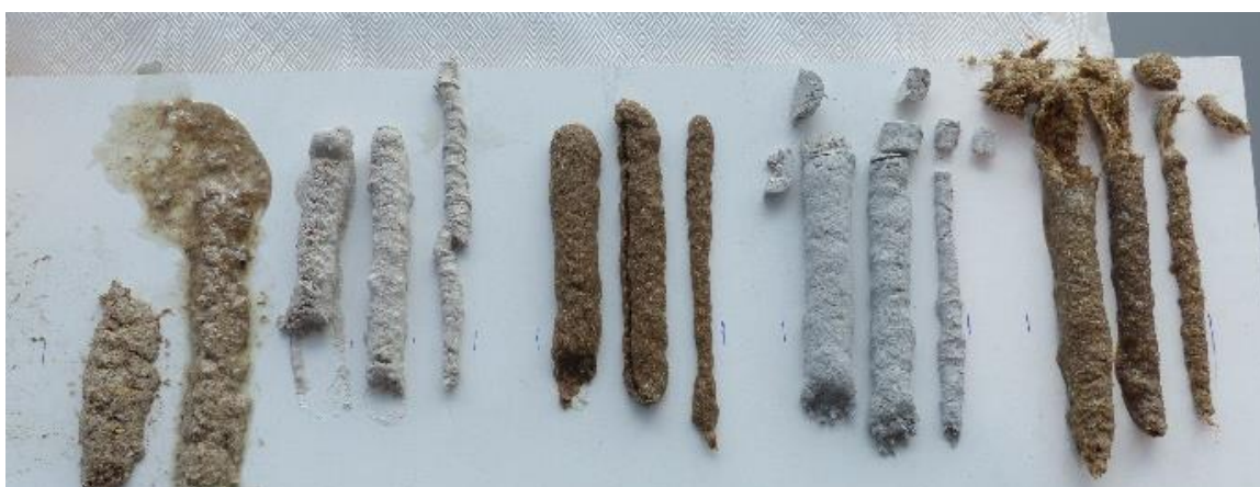
Figure 20 – De gedeponeerde strepen. Stukjes zijn afgesneden om de uitharding te bekijken. V.l.n.r: Allesvuller, muurvuller, behangplaksel, polyesterplamuur, contactlijm.
