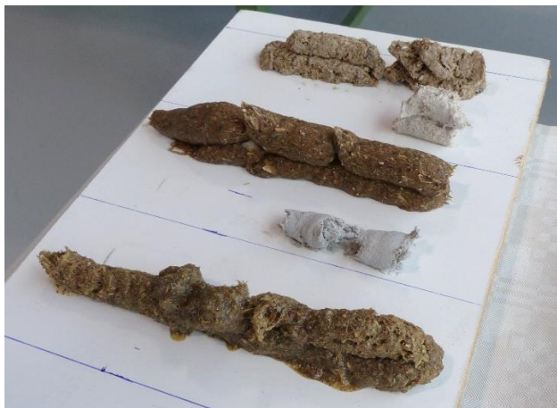
Figure 19 - Testen van de stapelbaarheid van verschillende lijmsoorten. V.o.n.b.: Contactlijm, polyesterplamuur, behangplaksel, muurvuller, allesvuller
