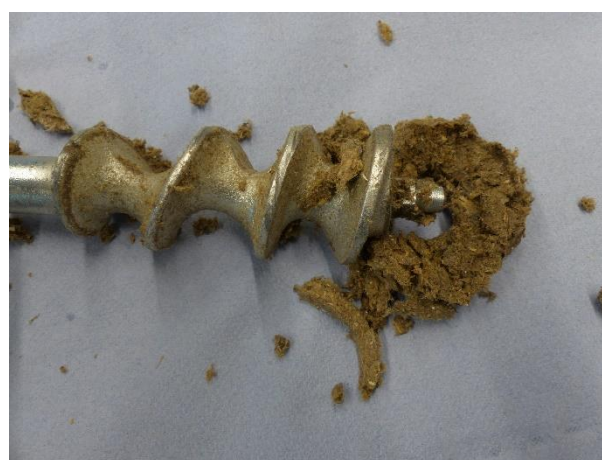
Figure 37 - Het mengsel is geperst, het blijft in de vorm van de schroef staan.
