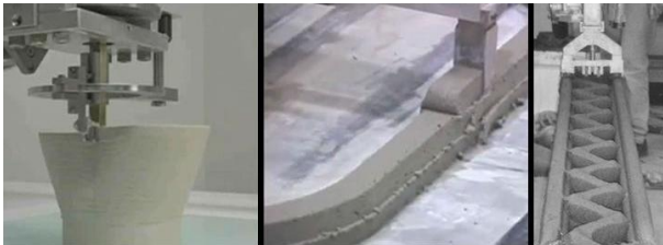
Figure 6 - Het printen van producten van cement met Contour-Crafting
