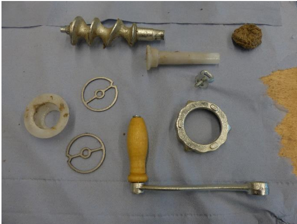
Figure 39 - De onderdelen van de vleesmolen na schoonmaken. Vanaf links met de klok mee: Gescheurde deel van de trechter, ringen ter vervanging van de gatenschijf, de schroef met materiaalverplaatsing van rechts naar links, tweede deel trechter, blokje van het uitgeharde mengsel, schroefring om de hendel vast te zetten, schroefring om de onderdelen in de molen te vast te zetten, de hendel.
