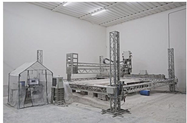
Figure 68 - Cartesiaanse 3D printer van Enrico Dini die werkt met een powder bed systeem
