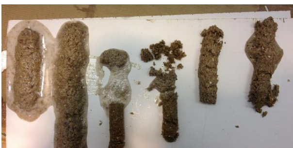
Figure 25 - Geëxtrudeerde strepen, lage percentages. V.l.n.r.: 9,1%; 16,7%; 28,6%; 33,3%, 2x 23,1% zaagsel.
