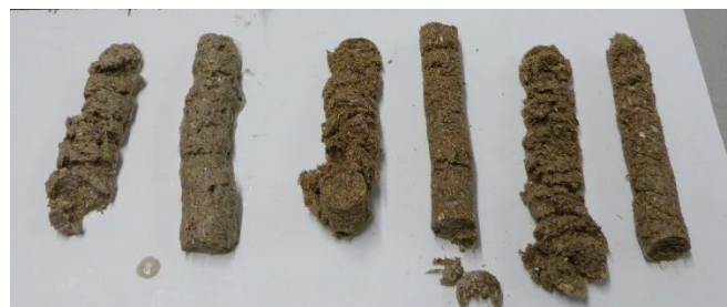
Figure 28 - Geëxtrudeerde strepen, hoge percentages. V.l.n.r.: 2x 23,1%; 2x 41,2%; 2x 33,3% zaagsel.
