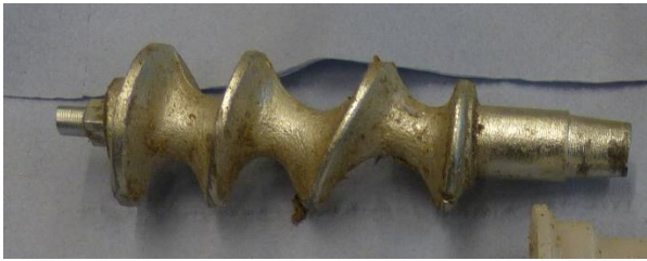
Figure 45 - De schroef van de vleesmolen, extrusierichting is van rechts naar links.
