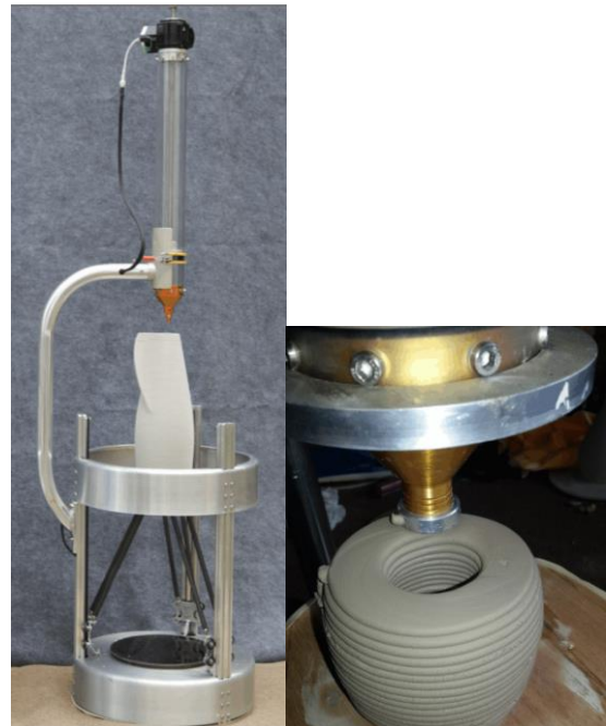
Figure 8 – Links een Potterbot, rechts een test met een spuitmond van 16 mm.
