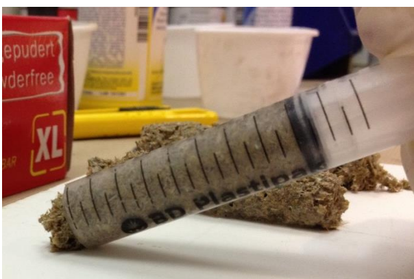
Figure 24 - Spuit wordt schuin gehouden bij extrusie
