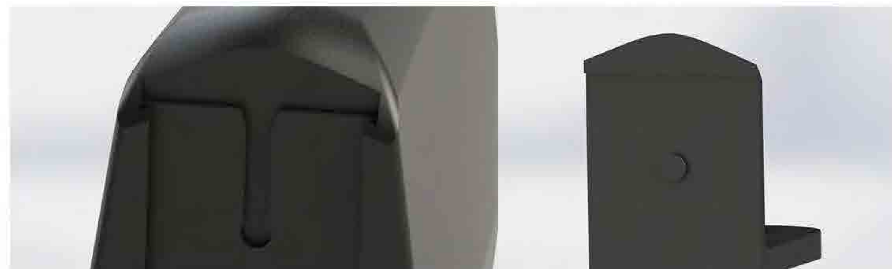
Fig. 53. het klikstelsel, met op de schuif het rondje en op de behuizing de gleuf
