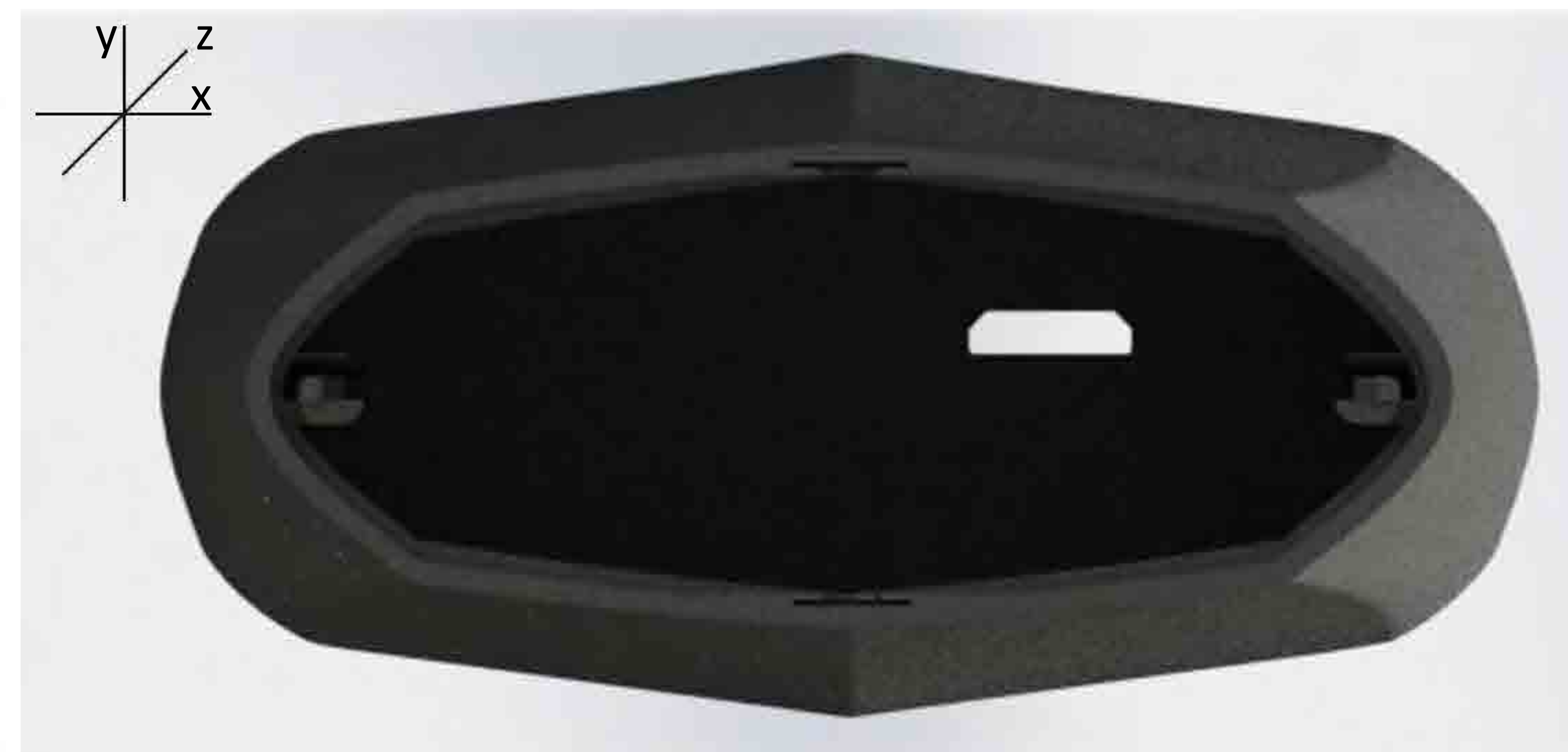
Fig. 42. Achteraanzicht van het product zonder de klep, met de rails links en rechts zichtbaar
