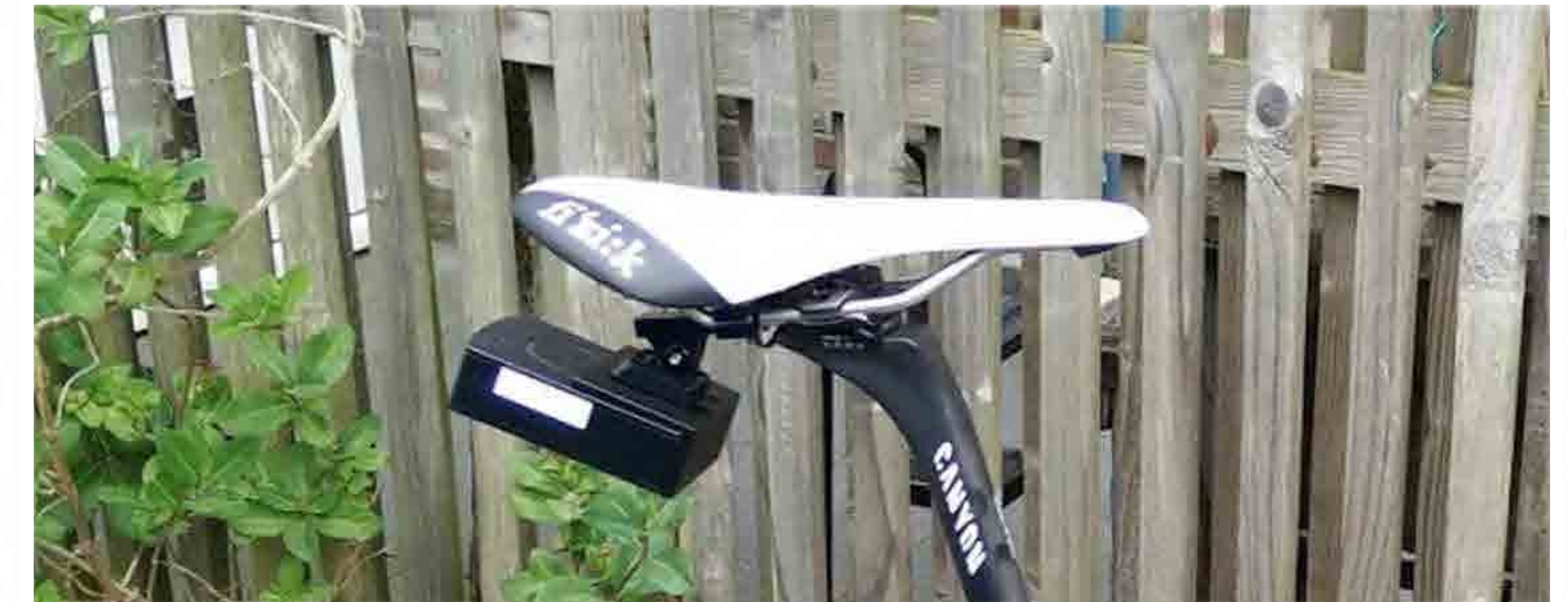
Fig. 71. Het product door middel van het 3D geprinte klepje achter het zadel te plaatsen
