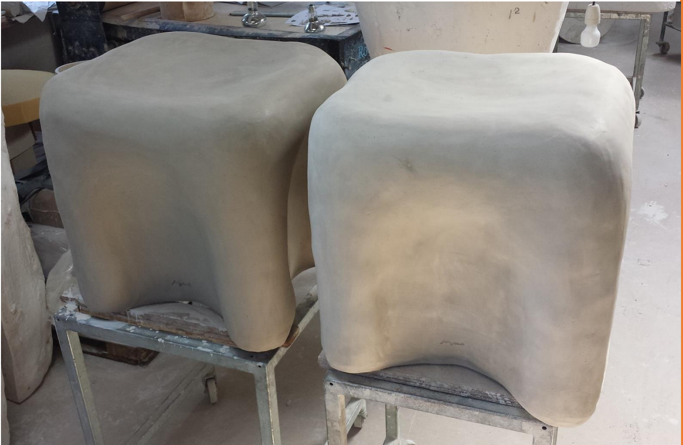
Figuur 64: Omdat het om een nieuw product gaat en het nog niet zeker is hoe het model zich houdt in de oven, is er een tweede model (links) gemaakt.
