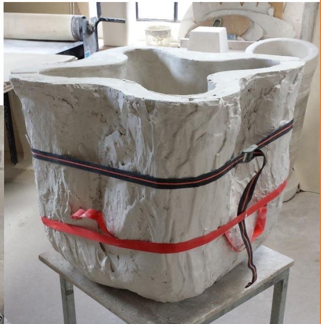
Figuur 60: Mal wordt bij elkaar gehouden met spanbanden
