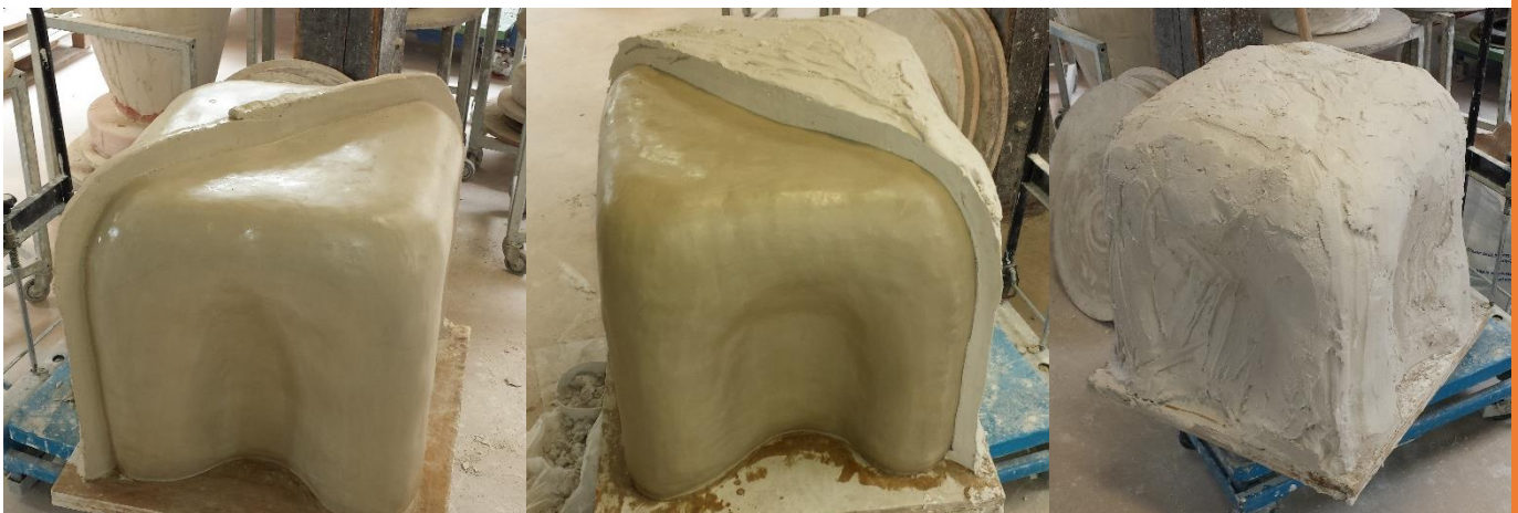
Figuur 59: Proces van de mal maken
