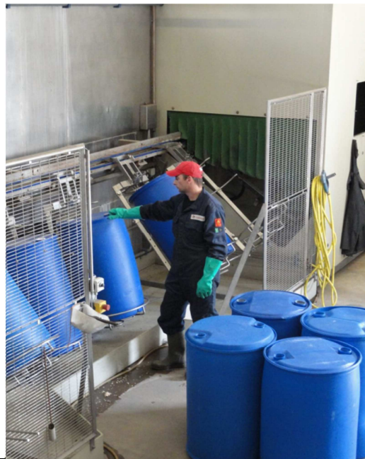
Afbeelding 5: Vaten in de automatische spoelmachine 5
