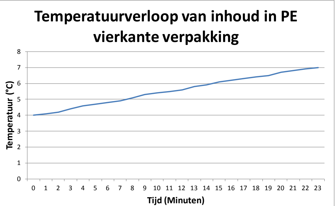
Grafiek 9. Temperatuurverloop in PE vierkante verpakking
