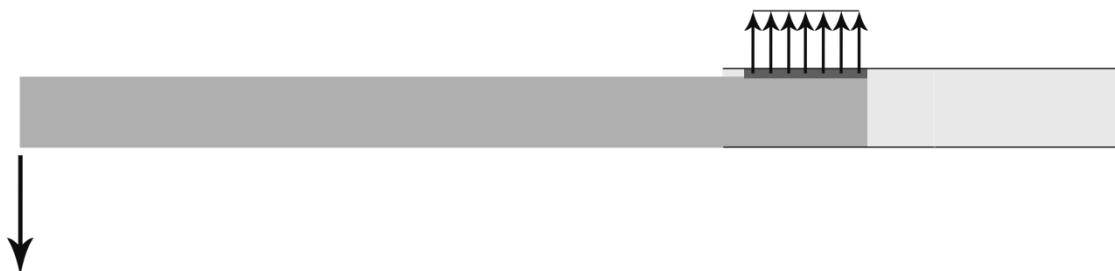
Figuur 25. De verdeelde belasting op het stukje POM (zijaanzicht)
