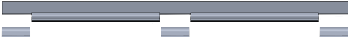
Figuur 18. Scharnierdeel met drie scharniersteunen
