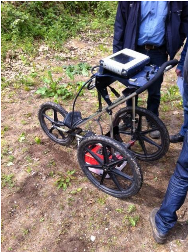
Figuur 14: Grondradar, in gebruik door Terra Carta.
