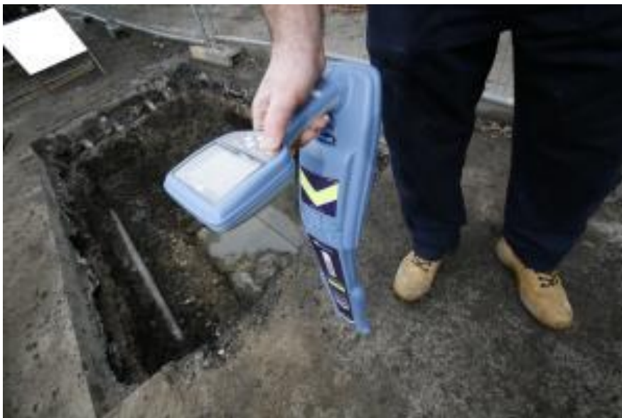
Figuur 15: Radiodetectie apparatuur, kabelzoeker (UC Underground Construction, 2009).
