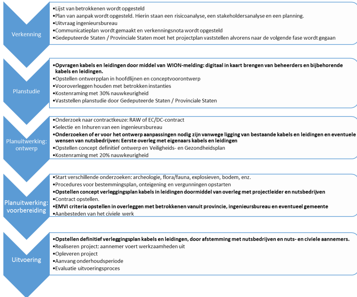
Figuur 13 Processchema aanpak infrastructurele projecten door provincie Overijssel
