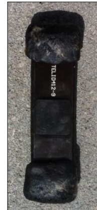
FIGUUR 15 SENSOR IN BITUMENBAND
