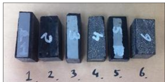
FIGUUR 14 - TWEE SOORTEN GIETASFALT PLAATSING
