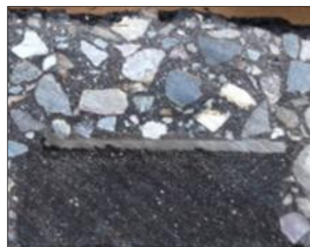
FIGUUR 23 - SENSOR OP GIETASFALT
