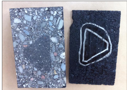
FIGUUR 24 - VERSMELTING GIETASFALT
