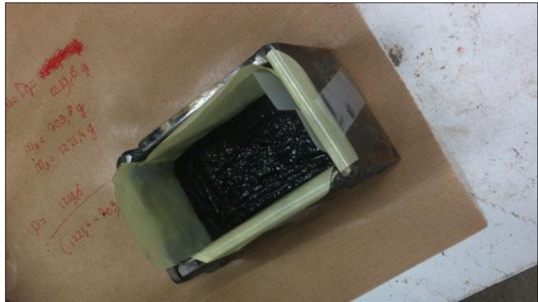
FIGUUR 13 GIETASFALT IN MAL
